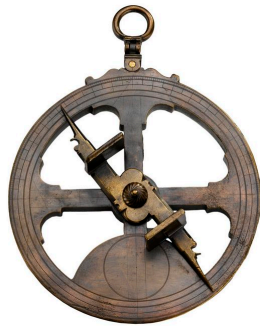
Slika 7.1 Astrolab – viseči krog z namerilno palico za merjenje višine nebesnih teles nad obzorjem. Prikazana je replika instrumenta, ki je služil španskim jadralcem pri prvih čezoceanskih plovbah. (National Maritime Museum, Greenwich)
