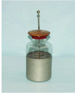
Slika 24.5 Električni kondenzator – naprava za shranjevanje naboja. (Niigata University)
