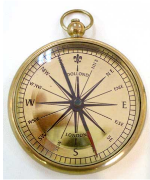
Slika 24.7 Kompas – magnetna igla, vrtljiva okrog navpične osi. Če je nič ne moti, kaže proti Zemljinem severnem in južnem geomagnetnem polu. Prikazana je replika žepnega kompasa iz dobe parnikov. (Dollond, London)
