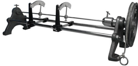
Slika 20.2 Priprava za merjenje zasuka žice. Vodoravno žico obremenimo z utežjo preko škriпча. Zasuk pokažeta dva kazalca. Je sorazmeren z navorom. (Altec Lab Equipment)
