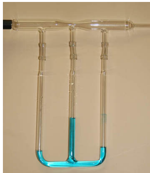
Slika 20.10 Ožinski tokomer za zrak. Pretok zraka skozi cev je enolično določen s tlačno razliko med njenim širokim in ozkim delom. S tem sta določeni tudi povprečni hitrosti na obeh mestih. (HyperPhysics)
