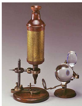
Slika 12.11 Replika mikroskopa za gledanje drobnih premetov, ki ga je uporabljal R. Hooke. Opazovani predmet je osvetljevan s svečo skozi zbiralno stekleno kroglo. (Science Museum, London)
