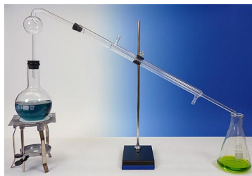
Slika 11.5 Pribor za destilacijo. Hlajenje vročih plinov v izhodni cevi poteka z vodnim prototokom od spodaj navzgor. (Anon)
