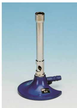
Slika 11.3 Plinski gorilnik. Na kovinski priključek natakemo gumijasto cev, po kateri doteka svetilni plin. Z obračanjem kovinskega obroča uravnavamo velikost lukenj za dotok zraka in s tem jakost plamena. (Anon)
