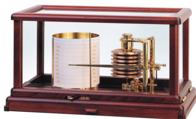
Slika 10.7 Aneroidni barograf. Izsesani kovinski meh se širi in krči pod vplivom zunanjega zračnega tlaka. Te spremembe se prenašajo na vzvod, ki piše po vrtečem se valju. (Anon)
