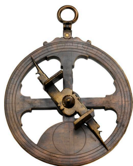
Slika 6.1 Astrolab – viseči krog z namerilno palico za merjenje višine nebesnih teles nad obzorjem. Prikazana je replika instrumenta, ki je služil španskim jadronicam pri prvih čezoceanskih plovbah. (National Maritime Museum, Greenwich)
